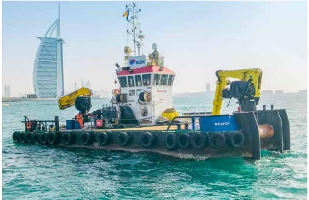
NOUVEAU NAVIRE DE TRAVAIL « WEAVER », d'une puissance de traction de 24 tonnes, utilisé pour déplacer des barges de grande taille et manipuler les ancres.
